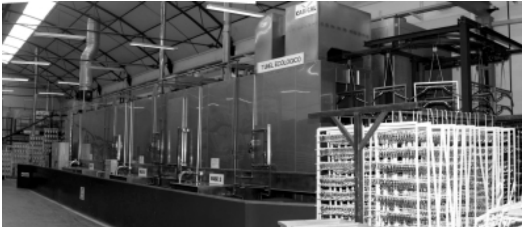
4 – El túnel de pretratamiento, a la izquierda. En paralelo, a la derecha, está el horno de secado
