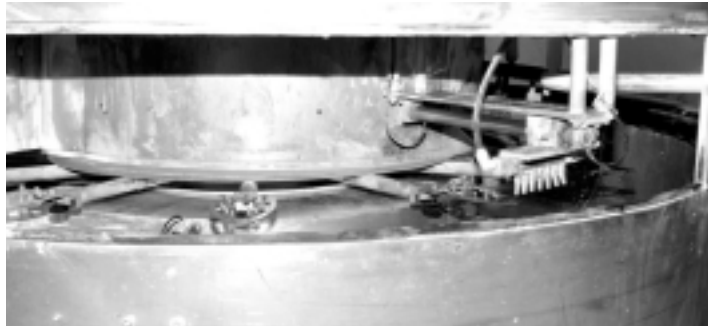
9 – Detalle de la zona de lavado y secado automático de las máscaras
