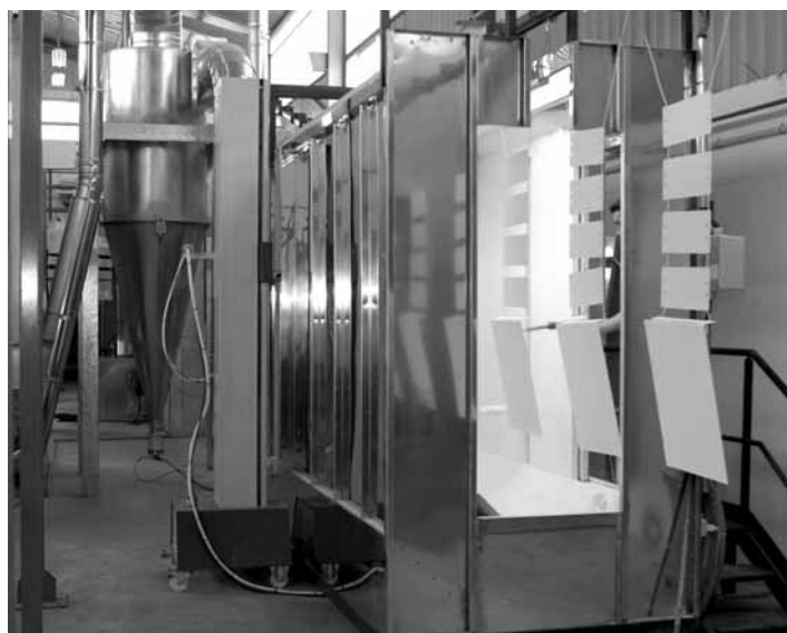
8 – La cabina de aplicación automática. Detrás de la cabina, a la izquierda, el ciclón separador.
