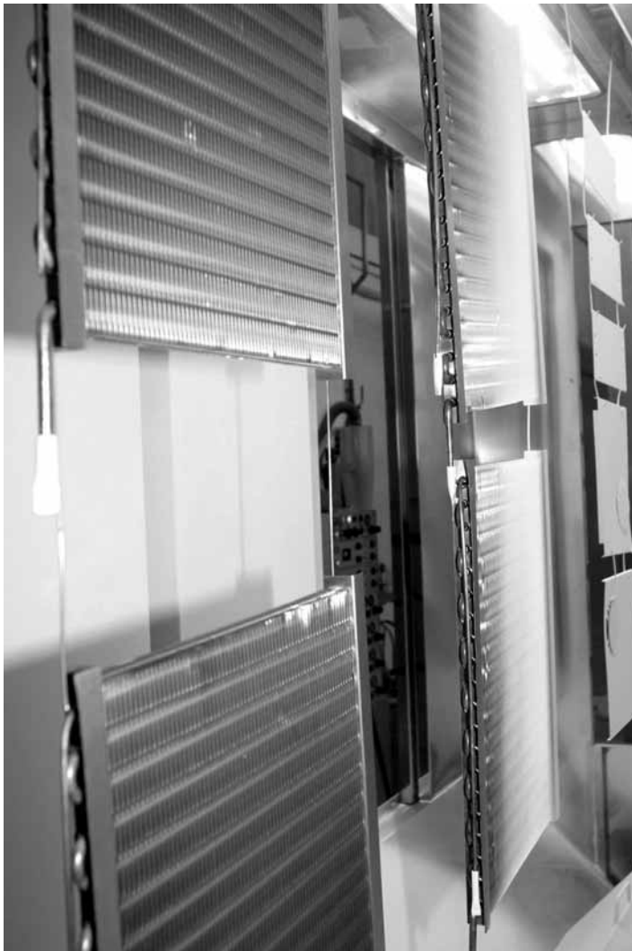
3 – Detalle de algunos intercambiadores térmicos en la cabina de aplicación.
