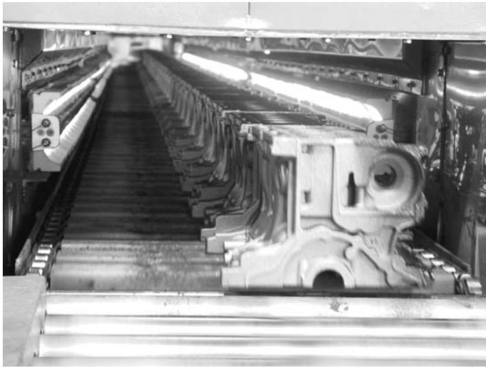
6 – Una vista del interior del horno. En este caso los bloques de motor se han recubierto sólo por un lado y los emisores se regulan en consecuencia, para optimizar los consumos energéticos.
