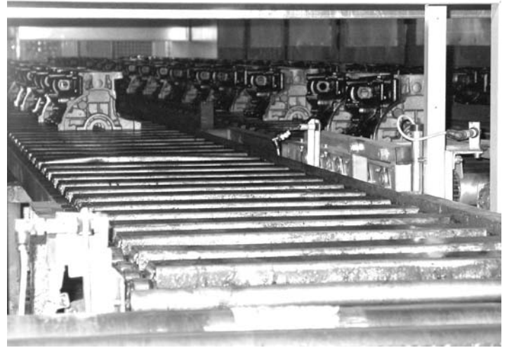
7 – El interior del túnel de enfriamiento.
