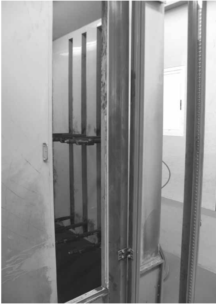
16 - Un detalle de la cabina de colores, con paredes de plástico y fondo de acero inoxidable, antes de la puesta en marcha de las operaciones de cambio color, al final de la aplicación de polvo rojo en 1500 perfiles de aluminio. Como puede verse, las paredes están casi limpias. Delante de la entrada de la cabina se ven las dos barras de lectura de las piezas cargadas en cada bastidor.
