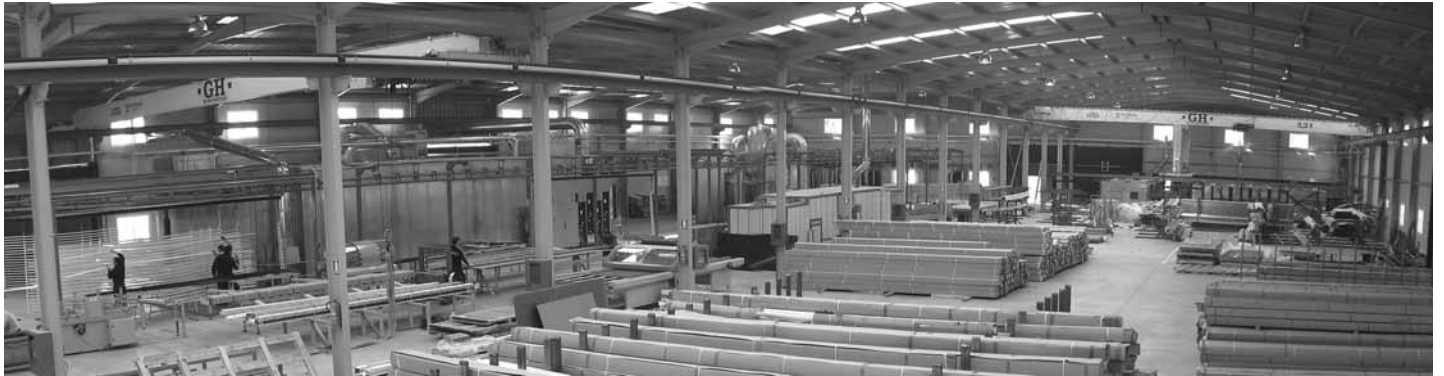
5 – El interior de la nave. De derecha a izquierda, en la parte inferior, el almacén de material en crudo ; al fondo, la línea de pretratamiento. A la izquierda, la instalación de lacado y la zona de embalaje.
