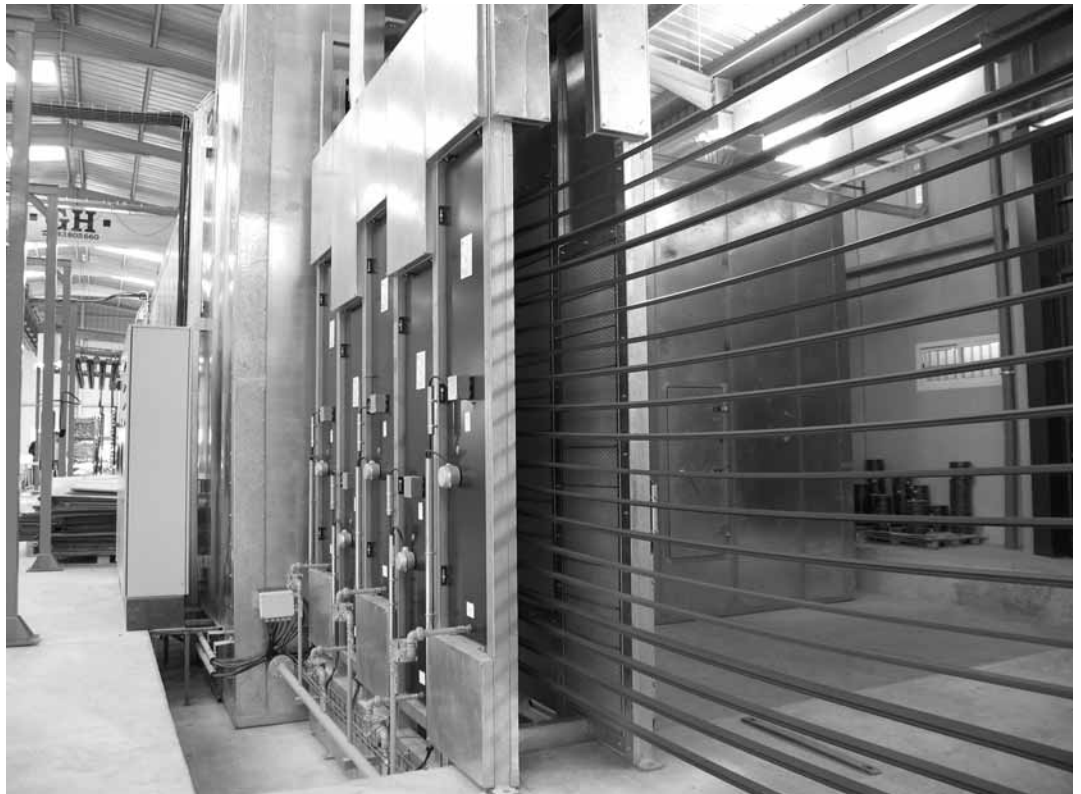
18 - El anillo IR en la entrada del horno de polimerización.
