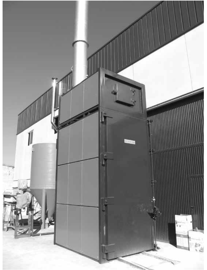
21 – El horno de decapado de pirólisis controlada (Foroni).
