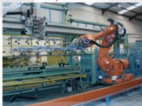
● Célula robotizada. Instalación montaje piso vehículo y pórtico manipulación CNC.
