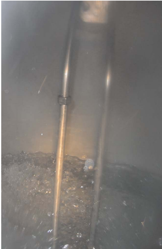
Detalle interior del reactor de evaporación (Tª de evaporación 40°C)
