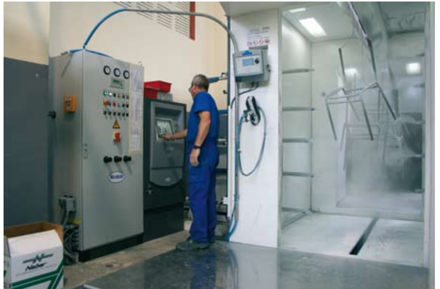
13 – Una fase de la aplicación con el nuevo sistema de aplicación “airless” (con las bombas que sustituyen al venturi y las grandes cantidades de aire comprimido típicas de los sistemas tradicionales).
