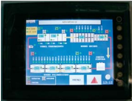
8 – La pantalla táctil instalada en el nuevo cuadro general de control y gestión de la línea reestructurada.
