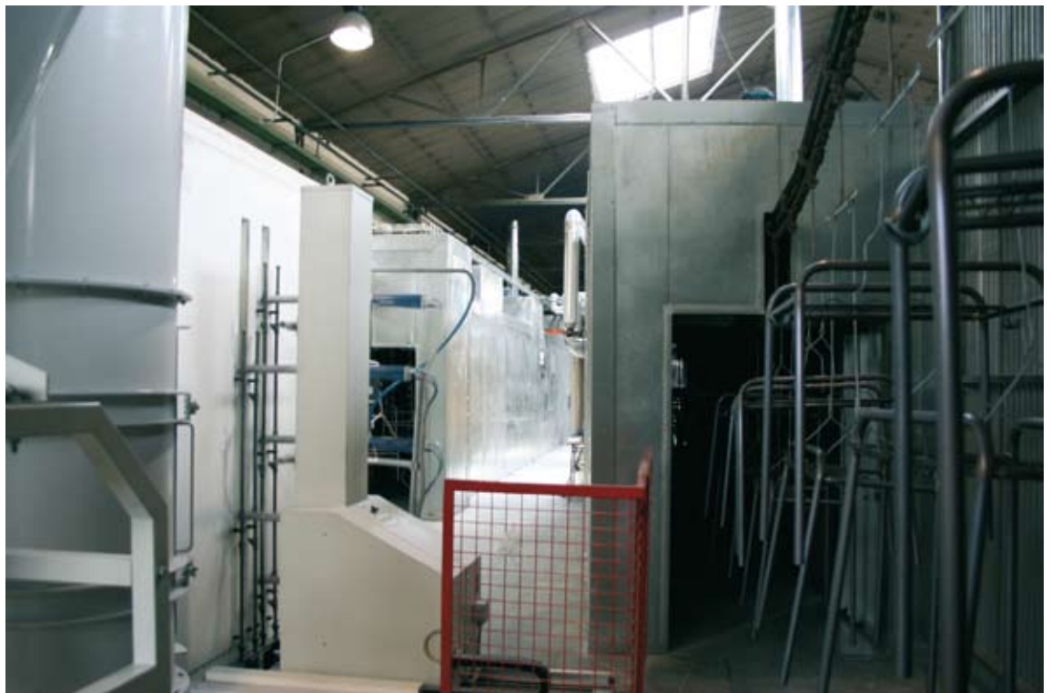
10 – A la derecha, la parte final del horno de secado y enfriamiento forzado.
