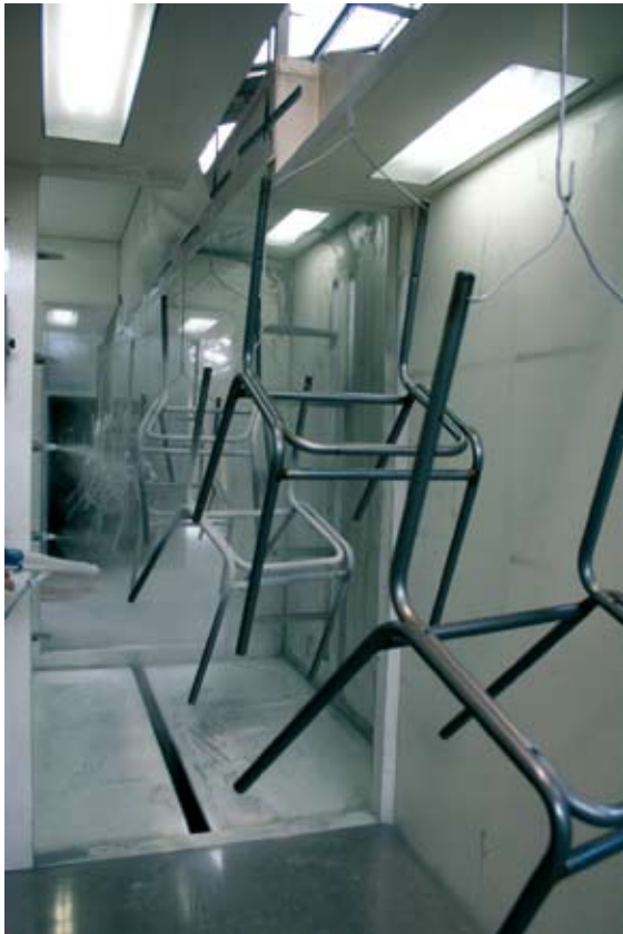
13 – Una fase de la aplicación con el nuevo sistema de aplicación “airless” (con las bombas que sustituyen al venturi y las grandes cantidades de aire comprimido típicas de los sistemas tradicionales).
