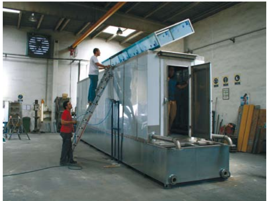
12 y 13 – En el taller, montaje y prueba de subcomponentes de una línea de pintura.
