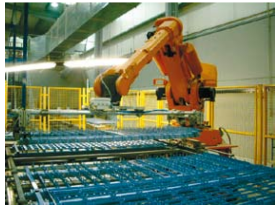
6 – La carga-descarga de las bandejas porta-piezas está robotizada.
