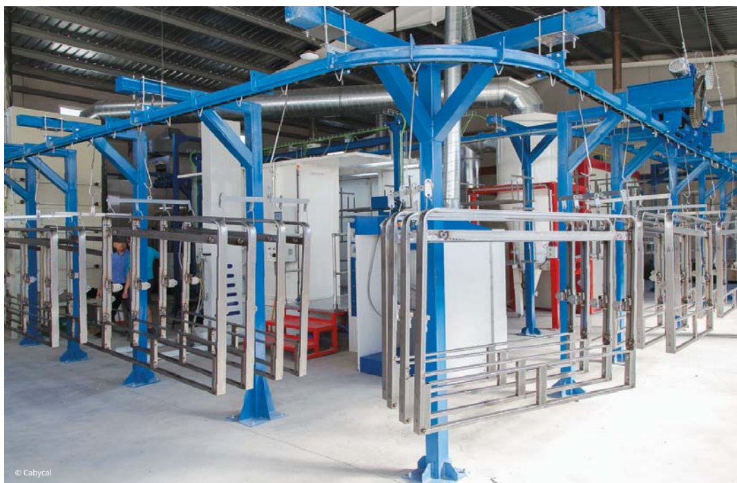
Panorâmica do sistema automático de pintura fornecido pela Cabycal.
