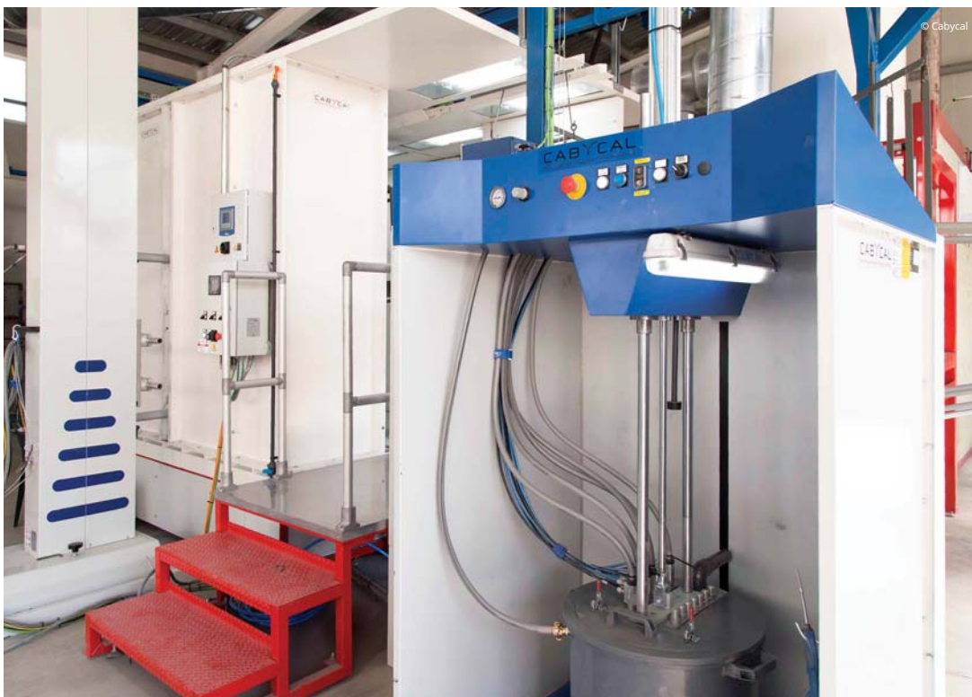
El centro de color con depósito de polvo de 69 kg.
