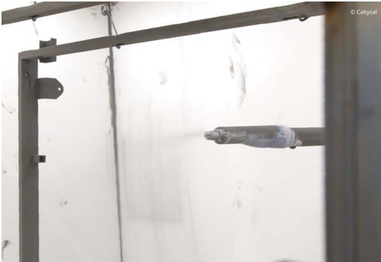
La aplicación de polvo se realiza con pistolas Nordson con sistema tradicional Venturi.
