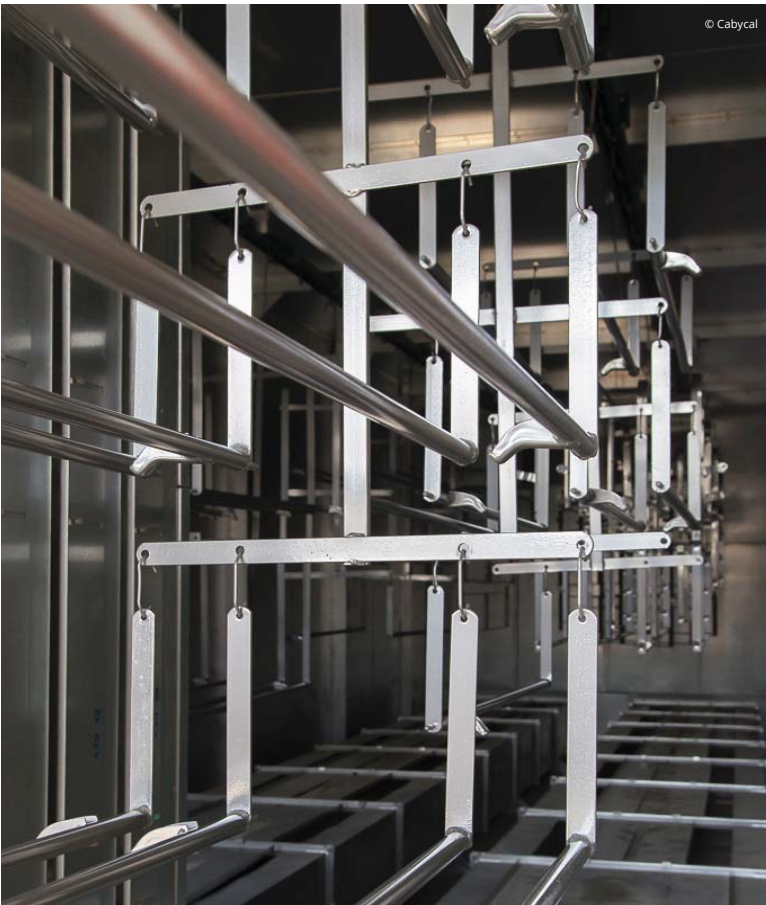
El interior del horno de polimerizado con combustión directa en vena de aire.
